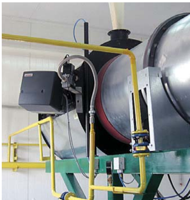
Горелка WG 20 на линии сушки яичной скорлупы
