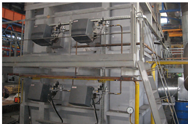
Горелки серии W на термической печи, г. Лиски
